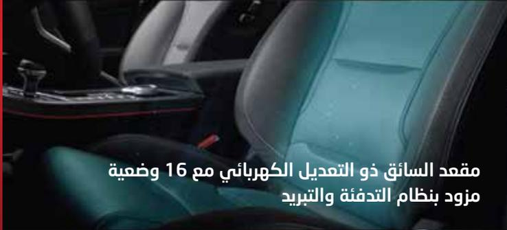
مقعد السائق ذو التعديل الكهربائي مع 16 وضعية
